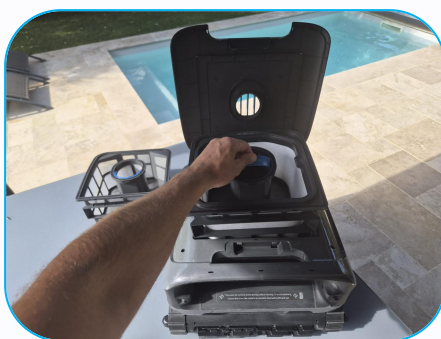
2. Mettre en place le kit 3 microns (panier + filtre)
